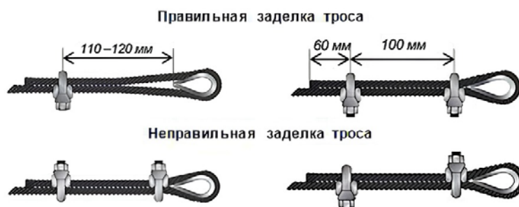
Рисунок 6 – Заделка троса
